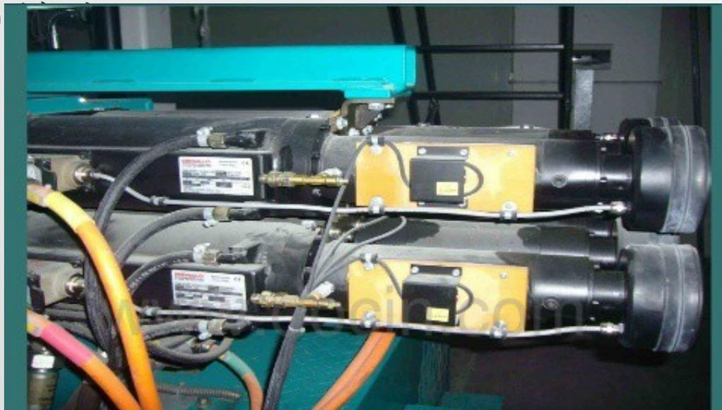
卡尔迈耶的 RS6EL 直线伺服电机控制的梳栉横移机构
