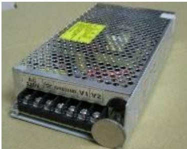
提示：如何知道电源功率是否足够？屏幕全亮，测量电源的接线柱的电压，应该在 5v-4.7v 之间。
